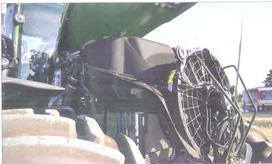
Das neue Lüfterkonzept. Der Lüfter liegt schräg nach oben geneigt vor dem Kühler. Lufthutze und Lüfterrad haben einen Spalt von nur 1 bis 2 mm. Dies soll mit zur deutlichen Wirkungsgradverbesserung des hydraulisch angetriebenen Lüfters beitragen.
