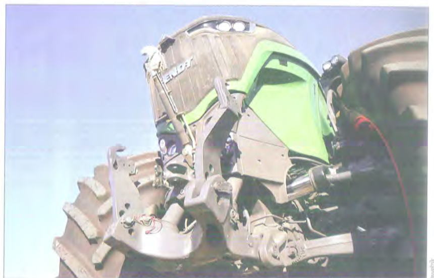
Das Fronthubwerk des neuen 1000er Vario stemmt rund 5,6 Tonnen.
