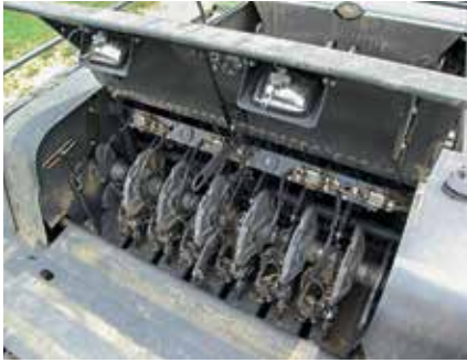
Ein serienmäßiges(!) Tangentialgebläse hält die Doppelknoter tipptopp sauber. Auch die Knoterschmierung ist Serie.
