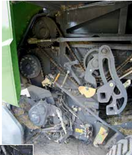
Fendt setzt auf Kettenantriebe und Reibkupplungen. Die 26 Messer (43,5 mm) sind bequem von links zugänglich und können in zwei Gruppen à 13 Stück geschaltet werden.
