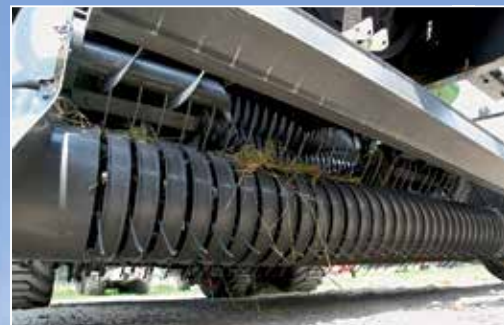
Die Pickup ist (von Zinken bis Zinken) 205 cm breit, hat vier gesteuerte Zinkenreihen und serienmäßig einen Rollenniederhalter.
