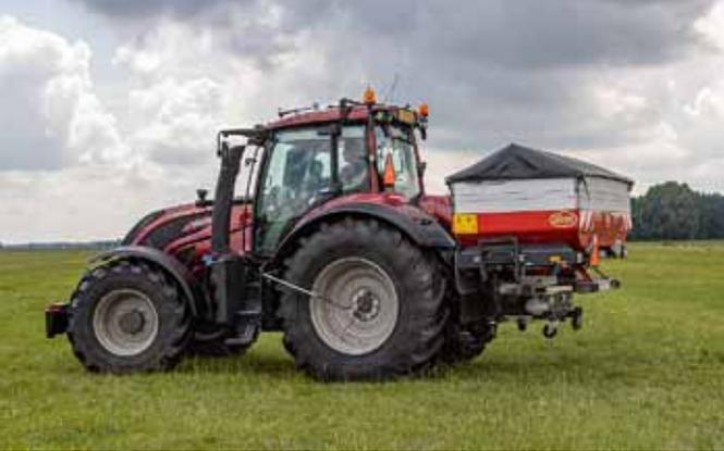
Der Valtra T174 Direct von Thijssen hat Michelin XeoBib-Reifen mit Reifendruckregelung für minimalen Bodendruck.
