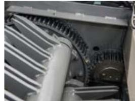
**1. Robust und langlebig.** Der Antriebsstrang besteht aus groß dimensionierten Stirnrädern, welche die Kraft laufruhig und verschleißarm auf das Schwingeaggregat übertragen. Der äußerst wartungsarme Antrieb spart Ihnen Zeit und Geld bei der Instandhaltung des Wagens.
