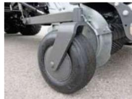
**5. Durch die seitlichen Tasträder** ist immer eine zuverlässige Führung der Pick-Up gegeben. Mit den optional nachlaufgelenkten Tasträdern, wird die Grasnarbe auch bei engen Wendemanövern geschont.
