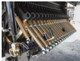
**5. Die Schneidwerke der PR/VR und XR Baureihen** haben alle eine theoretische Schnittlänge von 37 mm. Bei PR und VR kommen 40 und beim XR 45 Messer zum Einsatz. Alle Messer sind einzeln gegen Fremdkörper gesichert. Mit der Gruppenschaltung ist der halbe Messersatz einfach aus-schwenkbar.
