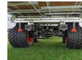
**4. Je nach Einsatzbereich** stehen bei dem Fahrwerk und der Bereifung zahlreiche Optionen zur Wahl. Der MR ist als sehr leichter Rotorwagen mit einem 17 t Fahrwerk und einer Bereifung bis zu 710/40 R22,5 ausrüstbar. Die optionale Nachlauflenkung verfügt in Verbindung mit ISOBUS über eine Automatik.
