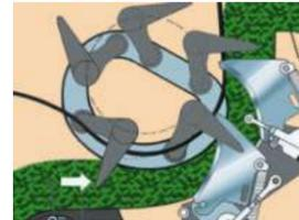
**2. Die Ladewagen der S & ST Baureihe** sind mit einem kurvenbahngesteuertem Schwingenaggregat mit bis zu fünf Schwingen ausgestattet. Bei der Abgabe im Laderaum werden die Förder schwingen somit geradlinig aus dem Futter herausgezogen, für besonders futterschonendes und kraftstoffsparendes Laden.
