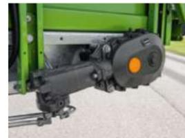
**7. Hydraulischer Kratzboden, serienmäßig!** Die Geschwindigkeit komfortabel einstellbar und es wird zum Abladen keine Zapfwelle benötigt. Mit den zwei Kratzbodenketten mit einer Gesamtbruchlast von 25 t wird jede Ladung zuverlässig entladen.
