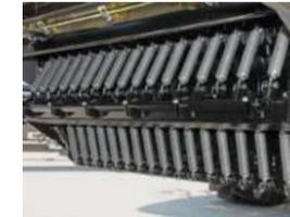
**2. Für jeden Einsatzzweck** ausrüstbar. Der serienmäßige Schneidrahmen in einem MS kann mit bis zu 17 Messern ausgestattet werden. Für Silage stehen weitere 16 Messer zur Verfügung, was zu einer Schnittlänge von 38 mm führt. Mit der hydraulischen Schneidwerksbetätigung und der Gruppenschaltung kann die Zahl der Messer schnell an die Bedürfnisse angepasst werden.
