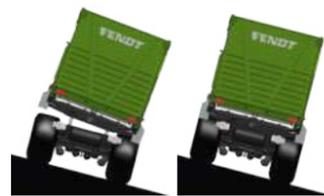
**7. Nicht einfach nur hydraulisch!** Die Fahrwerke der XR-Baureihe sind serienmäßig mit dem Fendt-StabilityControl (FSC) ausgestattet. Es handelt sich um eine intelligente Niveauregulierung, die ein einseitiges Einfedern verhindert. Das Ergebnis ist ein einzigartiger Fahrkomfort und eine extreme Standsicherheit des Wagens am Hang und in Kurven.
