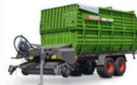
**4. Nicht nur beim Dürrfutter ein Profi!** Soll der Wagen zur Silagebergung eingesetzt werden, ist an Stelle des Dürrfuttersaufbaus auch ein Ganzstahlaufbau erhältlich. Zusammen mit dem Silierschneiderwerk und den 33 möglichen Messern, ergibt sich eine Schnittlänge von 38 mm.
