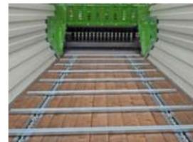
**6. Gerade im anspruchsvollen Gelände** muss ein Ladewagen so leicht wie nur möglich sein. Aus diesem Grund wird der Boden aus leichtem, beständigem und druckimprägniertem Holz gefertigt.
