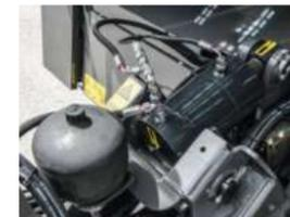
**5. Mit 40 km/h auf der Straße.** Für einen sicheren und komfortablen Transport auf der Straße steht eine Deichselfederung zur Wahl. Somit werden Stoßbelastungen auf den Schlepper reduziert und der Fahrer geschont.
