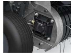
**2. Perfekt aufeinander abgestimmt.** Die hydraulisch angetriebene Pick-Up erlaubt flexible Drehzahlen zwischen Rotor und Pick-Up. Somit kann auf unterschiedlichste Bedingungen reagiert und die Schnittqualität gesteigert werden, da der Rotor besser befüllt wird. Durch die im Rahmen integrierte Bauform, ist der Antrieb komplett wartungsfrei.
