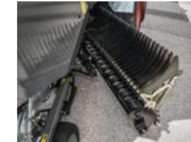
**3. Bei den Rotorladewagen der MR & MR Profi Baureihe** kommt ein Schneidwerk mit bis zu 31 Messern bei einer Schnittlänge von 45 mm zum Einsatz. Dank der Gruppenschaltung kann mit nur wenigen Handgriffen der halbe Messersatz aktiviert werden. Für maximalen Wartungskomfort schwenkt man den Messerrahmen optional seitlich aus.
