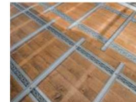
**6. Hydraulischer Kratzboden, serienmäßig!** Dank der Abladeautomatik erfolgt der Entladeprozess mit nur einem einzigen Knopfdruck. Auch schwere Silage ist für die bis zu vier Kratzbodenketten mit bis zu 50 t Gesamtbruchlast kein Problem.
